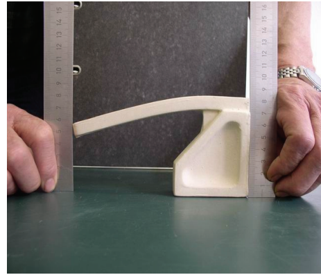
Şekil 1. Deformasyon ölçümü (Deformation measurement)
