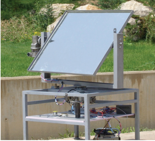
Şekil 4. İmalatı yapılan heliostatın deneme ve ayar anından bir görüntü. (Tracking test images: Picture of the experiment model)
