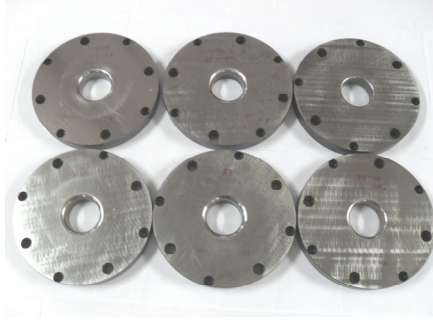
Şekil 5. Deney kalıpları (The dies used in experiment)
