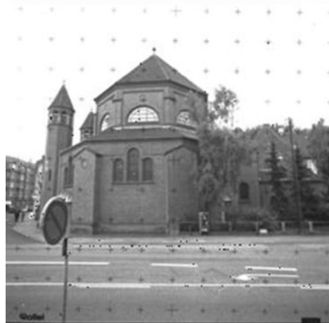
Şekil 4. Filmli, ağ sistemli fotoğraf makinesi - rolleiflex 6008 [8] ve pozlandırma sırasında film üzerine yansıyan ağ düzeni [2]
