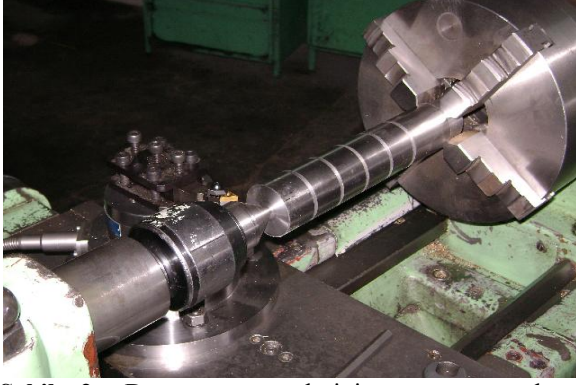
Şekil 2. Deney numunelerinin torna tezgahına bağlanması (Holding of experimental parts on the lathe)
