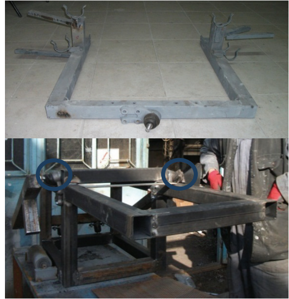
Şekil 1 a-b. Bıçak ve bıçağın yerleştirildiği mekanizma (Blade and the mechanism the blade is situated)
