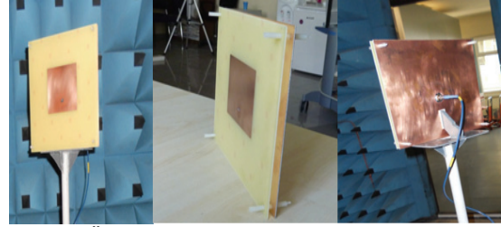
Şekil 5. Üretilen yüksek kazançlı mikroşerit yama antenin fotoğrafları. (Fabricated high gain microstrip patch antenna)
