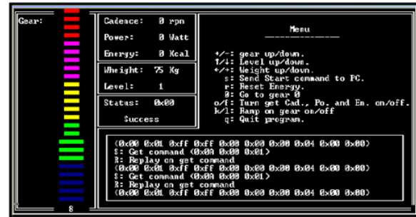
Şekil 9. Egzersiz bisikletinin dişli ve seviye ayarlarının yapıldığı simülör yazılımının arayüz görüntüsü (View of the IDE of the application simulator)
