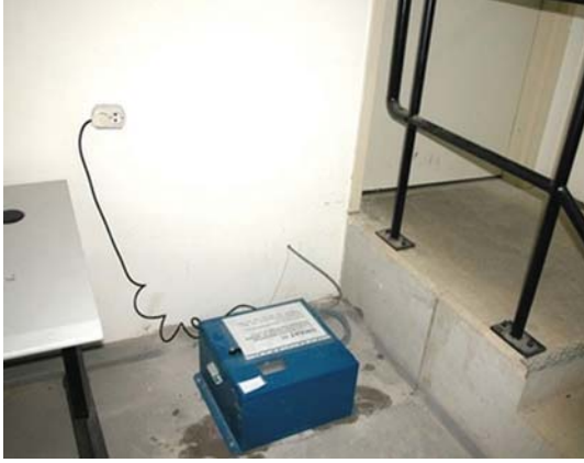
Şekil 9. Trakya Elektrik yapısal görüntüleme ve uyarı-alarm sisteminde kullanılan kuvvetli yer hareketi cihazı
