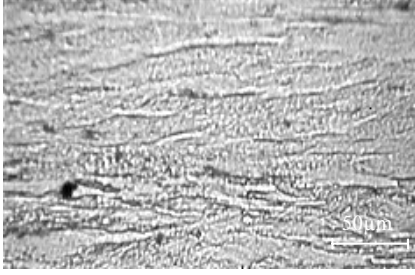
Şekil 5. 590°C'de 1 saat yeniden kristalleşme ısı işlemini görmüş Fe-%5.23V alaşımlarının mikroyapısı
