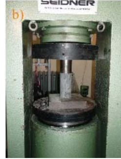
Şekil 4. Laboratuvar deneylerinden bazı görüntüler: a) Kayaçların porozitelerinin belirlenmesi b) Tek eksenli basınç dayanımı deneyi c) Deformabilite deneyi. Figure 4. Some schemes from laboratory tests: a) Determination of porosity of rocks b) Uniaxial compressive strength test c) Deformability Test
