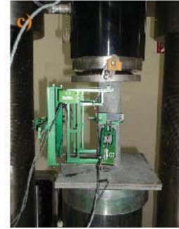
Şekil 4. Laboratuvar deneylerinden bazı görüntüler: a) Kayaçların porozitelerinin belirlenmesi b) Tek eksenli basınç dayanımı deneyi c) Deformabilite deneyi. Figure 4. Some schemes from laboratory tests: a) Determination of porosity of rocks b) Uniaxial compressive strength test c) Deformability Test
