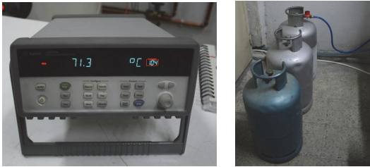
Şekil 7. Datalogger ile LPG tüpleri (Datalogger and LPG tanks)
