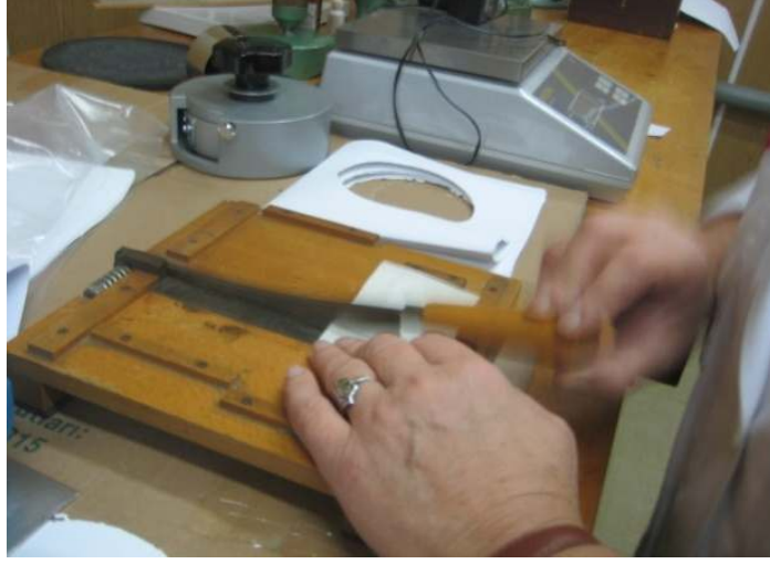
Fig.11. Giyotin ile kağıt örneklerinin kesilmesi.
