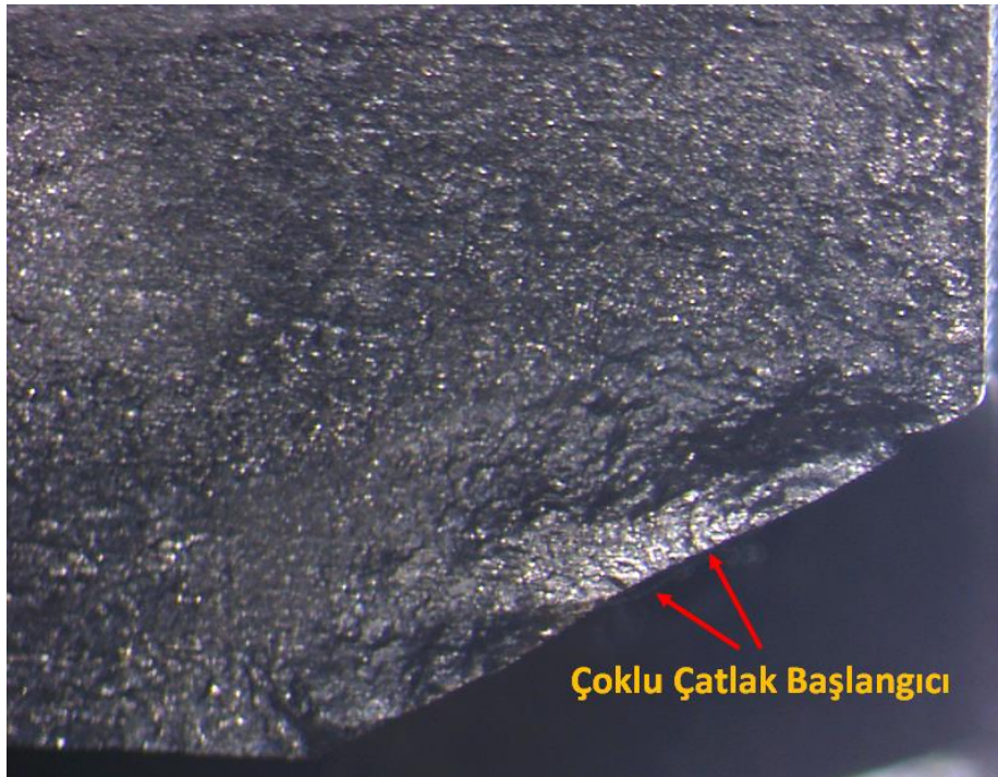
Şekil 16: Revize edilen kalıpta çatlak başlama yerlerinin anlaşılması için pres ile kırılması sonucu elde edilen yüzey. Çatlak oluşumunun başladığı konik yüzey kesit uzunluğu 6,70 mm'dir
