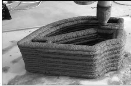
Şekil 1. 3D baskı yazıcı ile katmanlı üretim denemesi.
