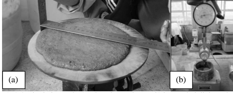
Şekil 4. 3D baskı harcında a) çökmede-yayılma ve b) batma derinliği yapılması
