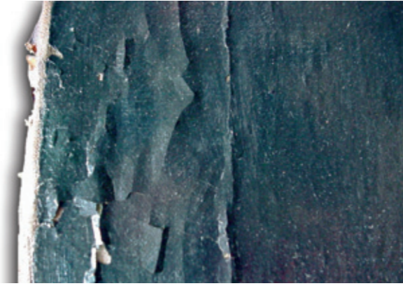
Resim 1. Boya Tabakasında Görülen Kabarmalar (Taşınabilir Kültür Varlıklarını Koruma ve Onarım Bölümü Laboratuvarı)
