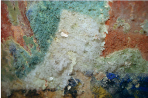
Resim 5. Boyada oluşan tozuma
