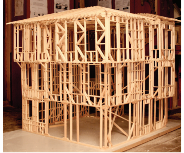
Resim 41. Öğrenciler tarafından yapılan taşıyıcı sistem maketi
