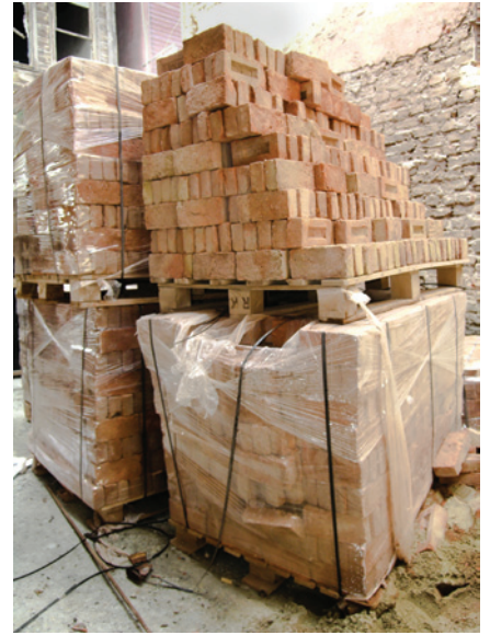
Resim 7. Özgünleri ile aynı boyuttaki yeni tuğlalar
