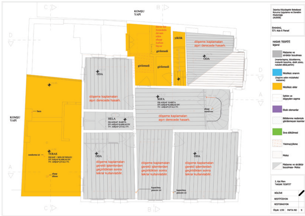
Şekil 3. Analitik Rölöve - 2. Kat planı, hasar tespiti
