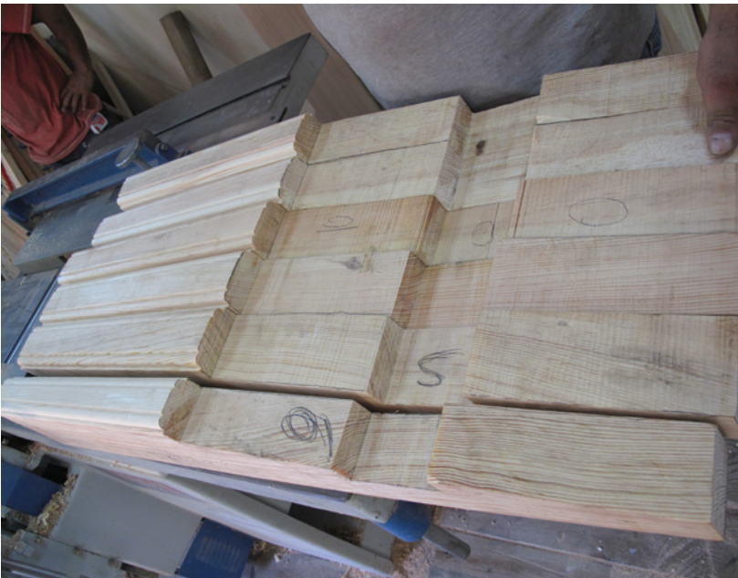
Resim 36. Bütünlemede kullanılmak için üretilen yeni kirişler
