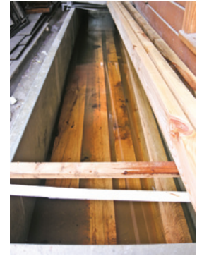
Resim 23. "Daldırma" yöntemiyle atölye ortamında emprenye
