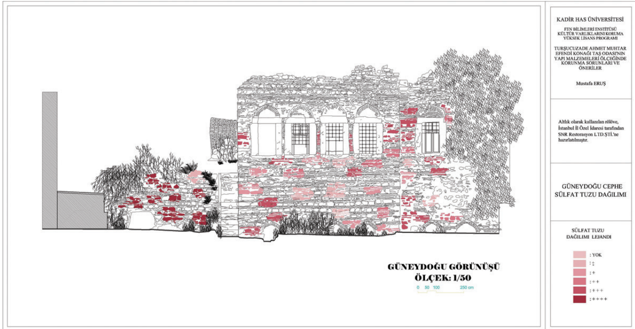
Şekil 19. Yapının güneydoğu cephesindeki sülfat (SO 4 2- ) tuzlarının dağılımı
