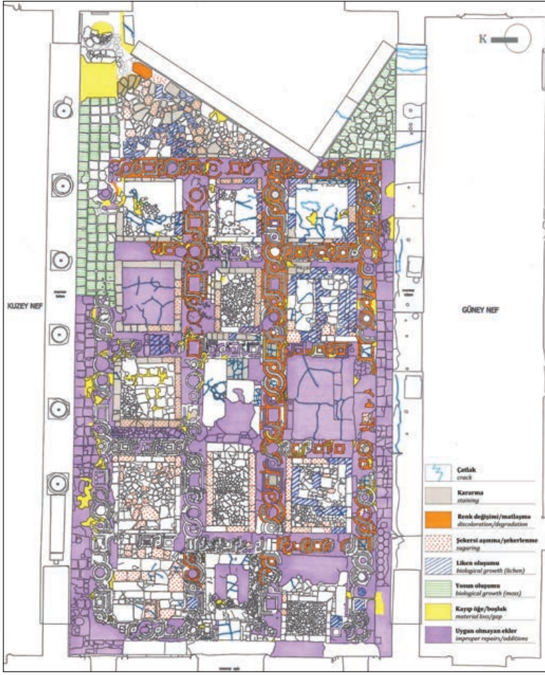
Şekil 50. Naos döşeme planı: Hasar tespiti
