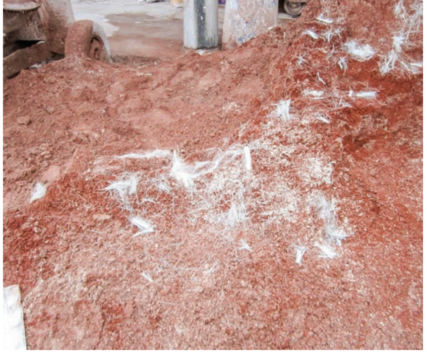
Şekil 7. Horasan harcında, keten kıtık katkı yerine günümüzde kullanılan polipropilen (PP) lifsel katkı.
