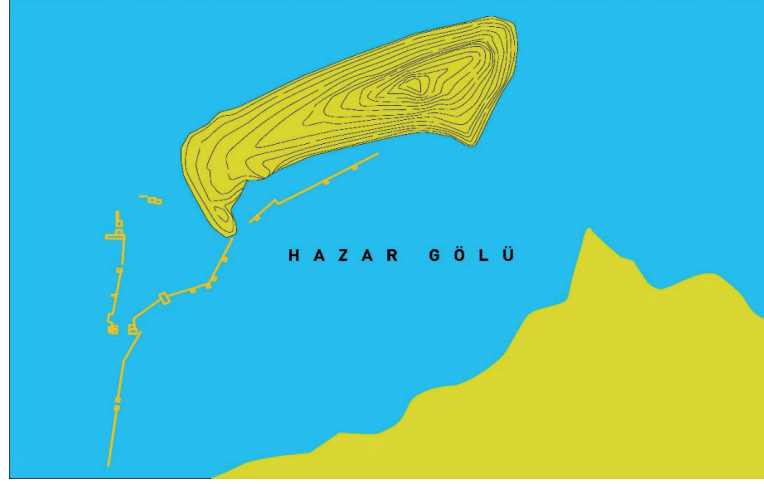
Resim 4 Çizim Total Station ölçümleri ile EGHAS -Etkileşimli Grafik Harita Sistemi kullanılarak yapılmıştır
