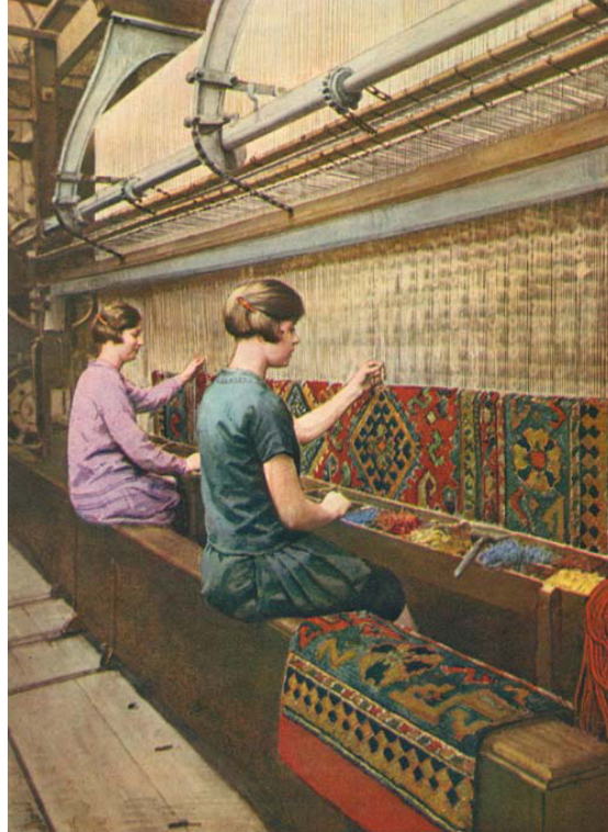
Resim 1: El tezgahlarında Batı Anadolu motiflerinden izler taşıyan halılar üreten Deventer Verenigde Tapijfabriek
