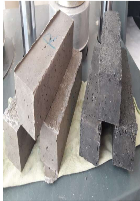
Şekil 6. Numunelerin Kalıptan Çıkarılması
