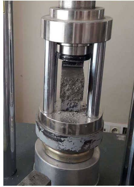
Şekil 8. Basınç Dayanımı Deneyi
