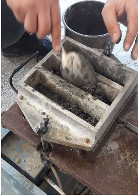
Şekil 5. Harçların Kalıba Yerleştirilmesi
