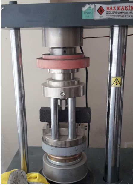
Şekil 7. Eğilme Dayanımı Deneyi
