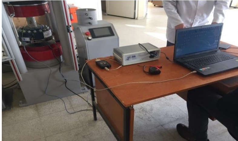
Şekil 5. Yeni numunelere basınç yüklemesi yapılması.
