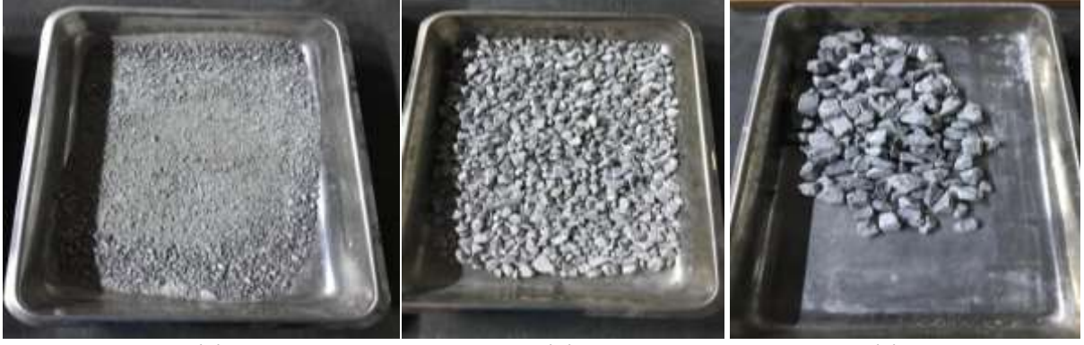
(a) (b) (c) Şekil 2. (a) 0/5 mm (b) 5/15 mm (c) 15/25 mm boyutlarındaki agregalar.
