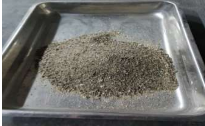
Şekil 5. Bolu Çimento A.Ş' den temin edilen GYFC numune örneği.
