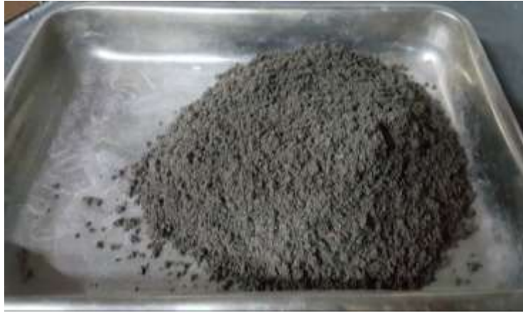
Şekil 3. Eren Enerji A.Ş taş ocağından temin edilen taban külü numunesi.
