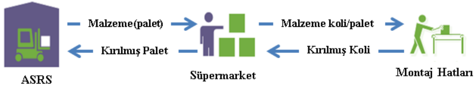
Şekil 2. ASRS ve Montaj Hatları Arasındaki Malzeme Akış Şeması
