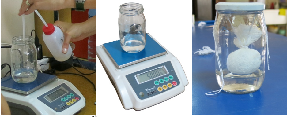
Resim 3. Paraloid® B-72'nin uygun çözünme için hazırlanması
