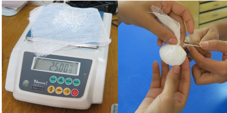
Resim 2. Katı Paraloid® B-72'nin uygun çözülmeye hazırlanması
