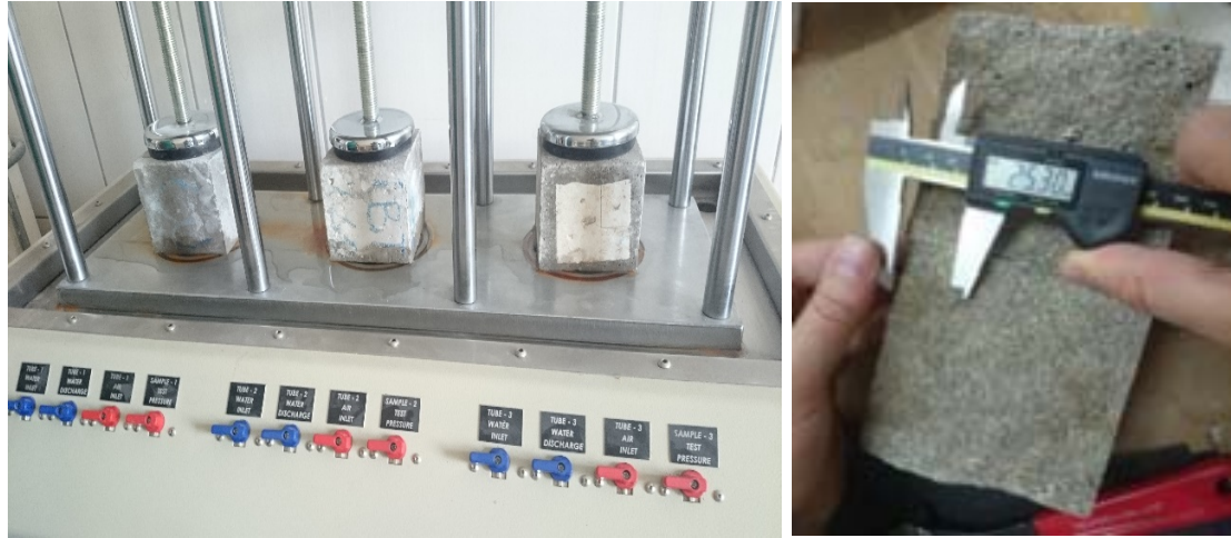
Şekil 1. Basınç altında su işleme derinliğinin tayini.
