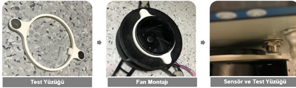
Şekil 3. Test yüzüğü fan montajı
