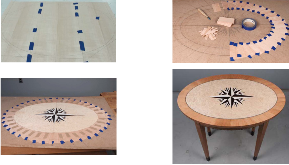
Şekil 3.2. Kaplama ile Kakma Uygulaması (Infinitytools, 2018)
