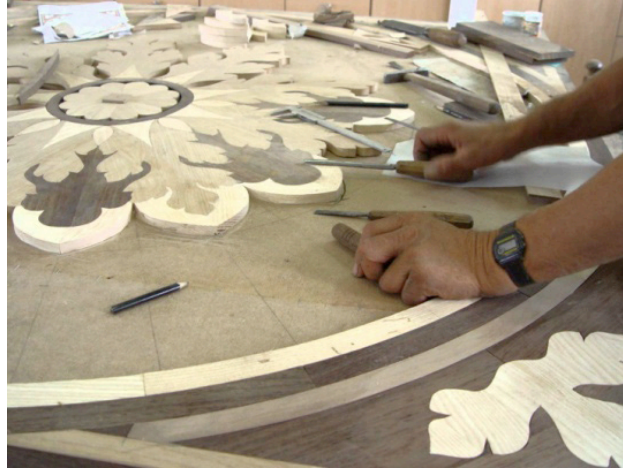
Şekil 3.1. Ahşap Kakma Uygulaması (Luxurywoodflooring, 2018)
