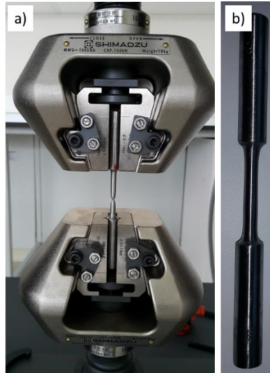
Şekil 2. Çekme test cihazı (a) ve test numunesi (b) (Tensile testing device (a) and test sample (b))
