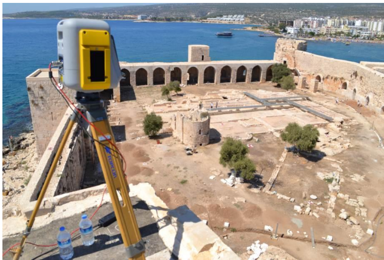
Şekil 10. Yersel lazer tarama işlemi
