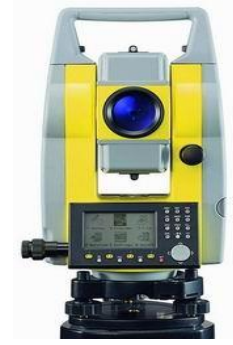
Şekil 5. Çalışmada kullanılan elektronik uzaklık ölçer (Geomax ZTS 605)
