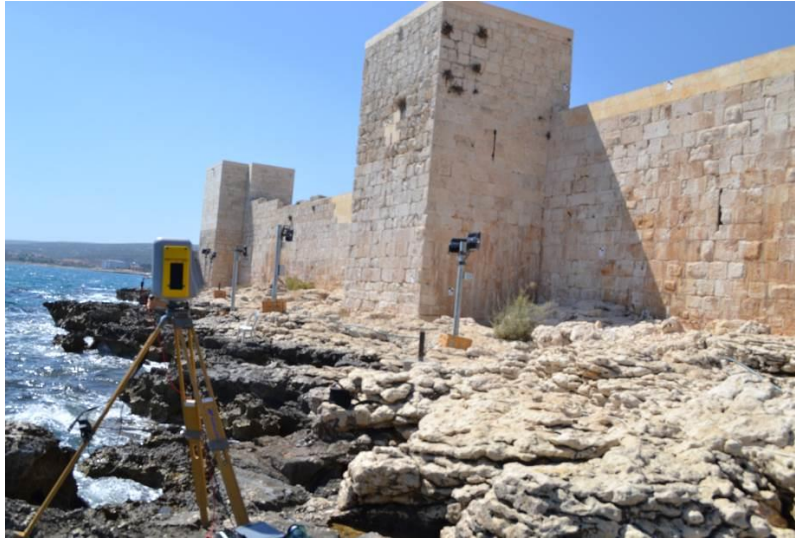
Şekil 11. Yersel lazer tarama işlemi
