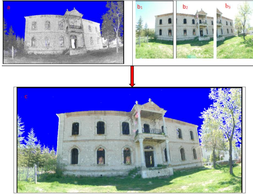
Şekil 9: Nokta bulutunun renklendirilmesi; a: renksiz nokta bulutu; b1, b2, b3: renklendirmede kullanılan fotoğraflar; c: renkli nokta bulutu.
