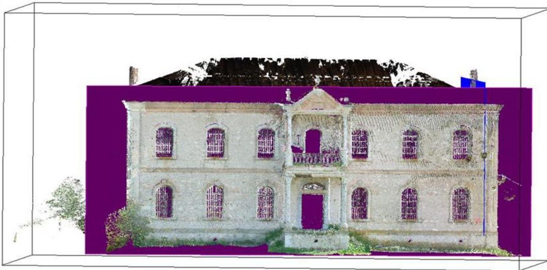
Şekil 11: Önce cephenin ortofoto görüntüsünün üretilmesi için kullanılan düzlem
