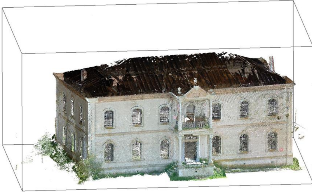
Şekil 10: Yapıya ait üretilen 3 boyutlu nokta bulutu.
