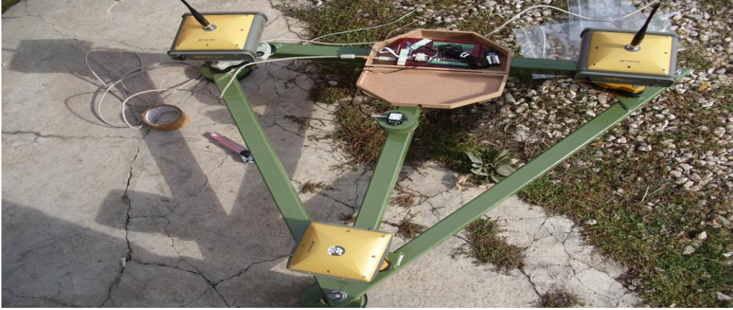
Şekil 1. GPS ve İvmeölçerin yerleştirildięi düzenek
