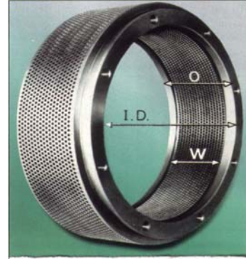
Şekil 3. Matris ve kısımları ID:Matrisin iç çapı O:Matrisin tüm genişliği W:Matrisin etkin olduğu genişlik
