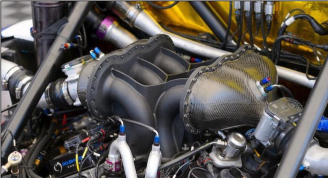
Şekil 5. SLS Yöntemi ile Üretilen Emme Manifold [8]
