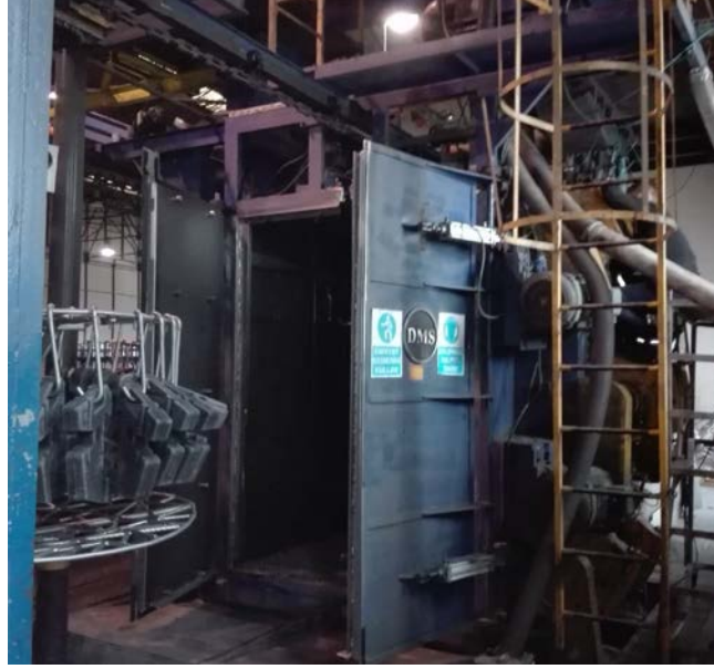
Şekil 3. Askılı kumlama makinesi (Figure 3. Hanger type shot blasting machine)
