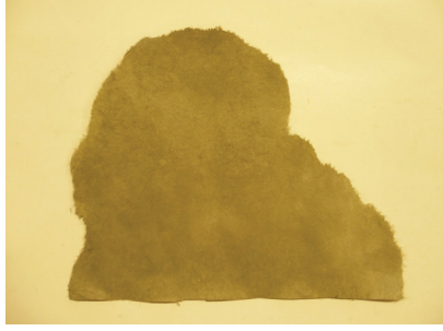
Şekil 24. Resim 23'te görülen yüzey kaybını tümlemek için seçilen kâğıt, akrilik boya ile uygun renk tonunda boyanarak tamamen kuruması beklenir. (Boyama işleminde fırça, hava tabancası veya daldırma yöntemi kullanılabilir)
