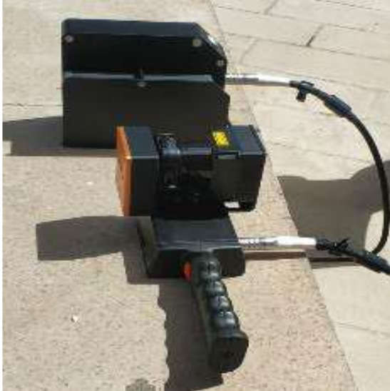
Şekil 2. "Geoslam" lazer tarama cihazı
