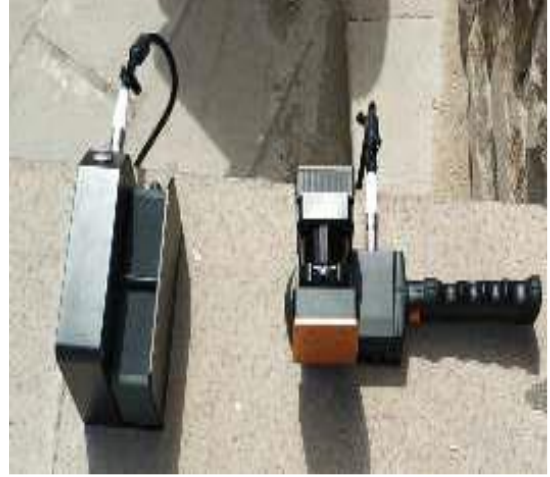
Şekil 3. "Geoslam" lazer tarama cihazı
