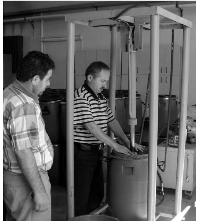
Şekil 1. Çalışmada kullanılan basıncı ayarlanabilir hidrolik pres.
