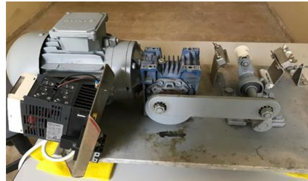
Şekil 3. Arsoy tarafından tasarlanan eğim test cihazı [17]
