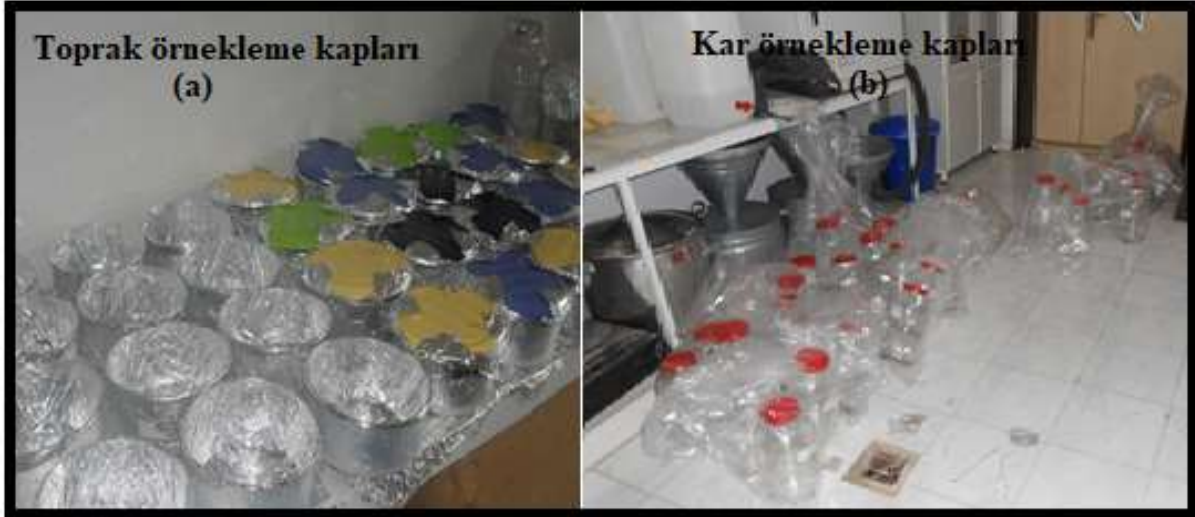
Şekil 4. Örneklemede kullanılan malzemelerin hazırlanmış son şekli (a) toprak örneği için hazırlanan alüminyum folyo ile sarılı kaplar, (b) Kar numunesi için hazırlanan 5 L'lik cam kavanozlar
