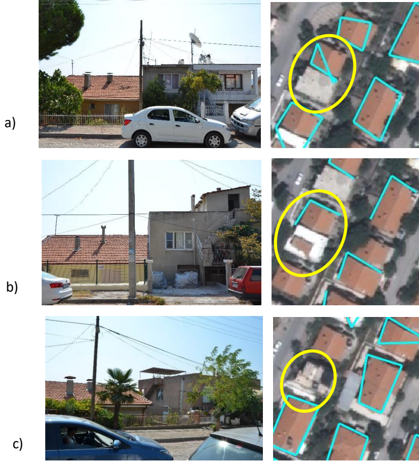
Şekil 15. Yaklaşımın bina sınırlarını çıkarmada tam başarılı olamamasına TA_4'ten bir örnek. a) ve b) Farklı yükseklik ve çatı özelliklerine sahip bitişik nizamlı binalar ve tespit edilemeyen bina sınırları, c) Bina üzerindeki ek kat ve tespit edilemeyen bina sınırı
