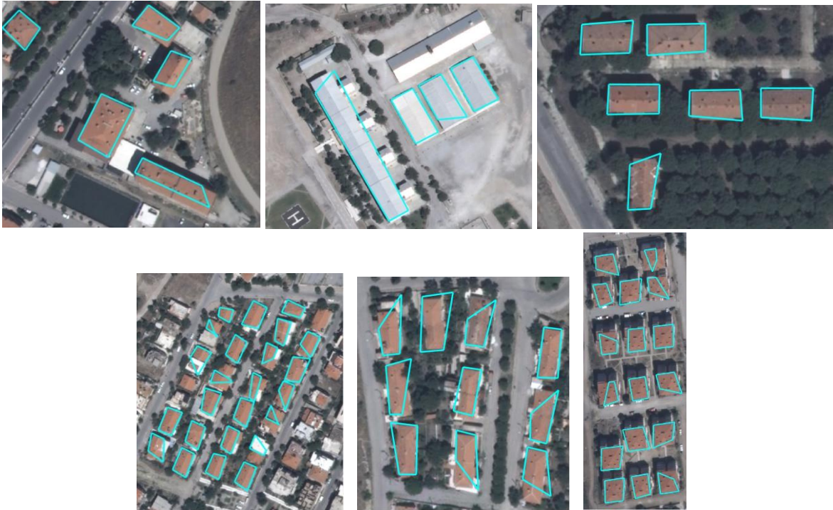
Şekil 10. Uygulanan yaklaşım ile test alanlarında çıkarılan bina sınırları
