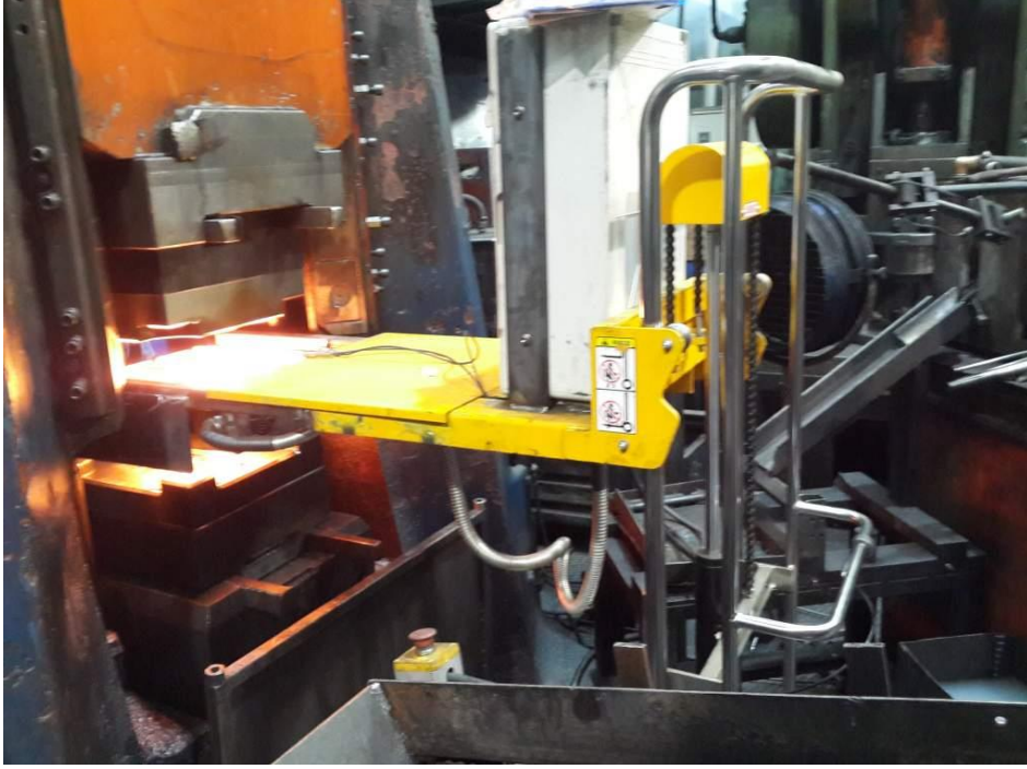
Şekil 7. Tasarlanan endüstriyel tip kalıp ısıtıcı
