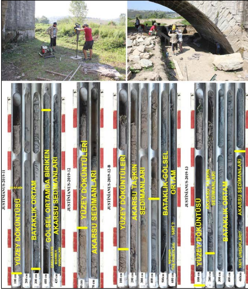
Şekil 8: JST-11, JST-12, JST-12-B ve JST-13 nolu sondaj çalışmalarını ve bu sondajlara ait ortam değerlendirmeleri.
