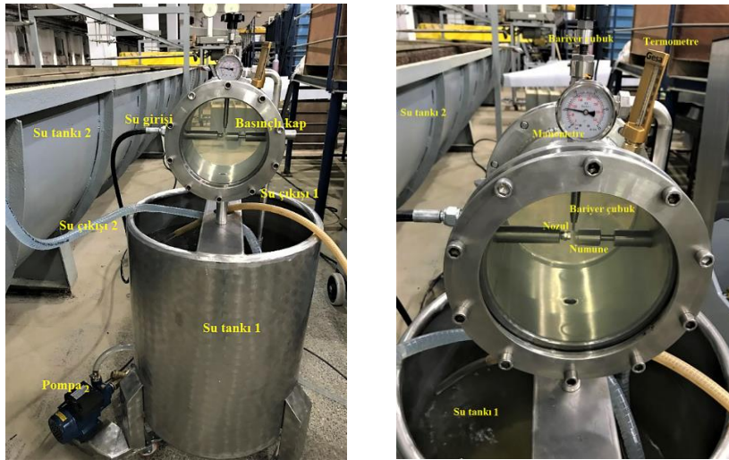
Şekil 12: İTÜ GİDB Fakültesi Ata Nutku Laboratuvarı'nda kurulan su jeti test düzeneği (Usta, 2018).
