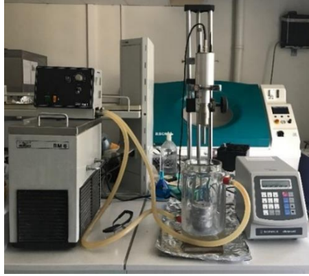
Şekil 5: İTÜ Kimya Metalurji Fakültesi'ndeki titreşimli erozyon testi cihazı.
