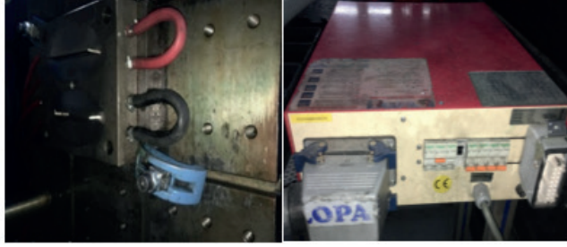
Şekil 6. Kademeli kalıp bağlama pabucu kolay bağlantı elemanı (sol), Sıcak yolluk sistemi iyileştirmesi (sağ)
