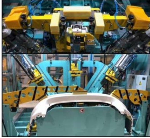
Şekil 3. Ultrasonik kaynak makinesi ve arka tampon ultrasonik kaynak pozisyonu
