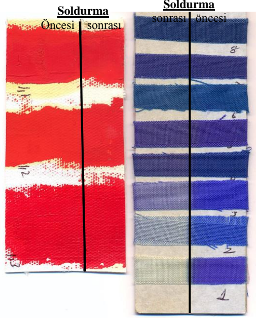
Resim 1. Blue Wool Scale ve soldurulan test boyamasının soldurma sonrası görüntüsü
